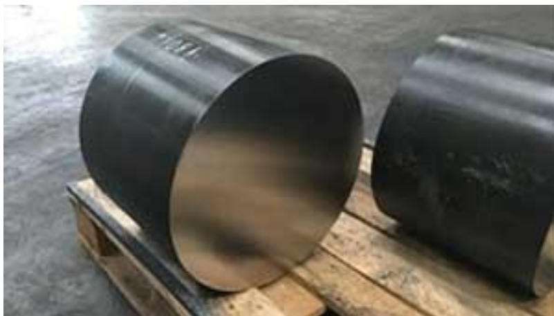
Фигура: Inconel 718 с диаметър 470 mm, обработен с високопроизводителен лентов трион FUTURA® 718
