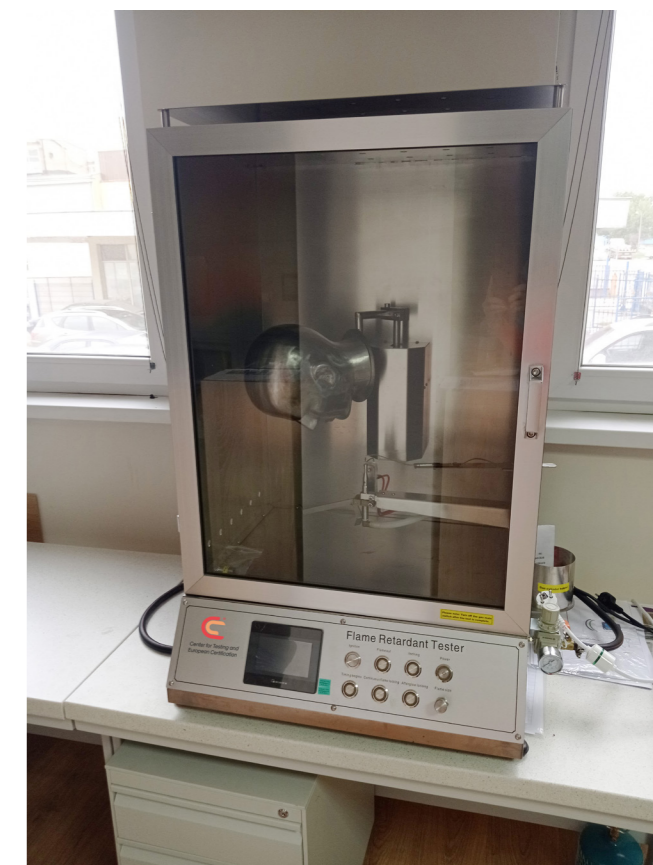
Тестово оборудване за възпламенимост
