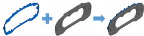
Фиг. 2 – Пример за многокомпонентно шприцване по метода с послойно шприцване
