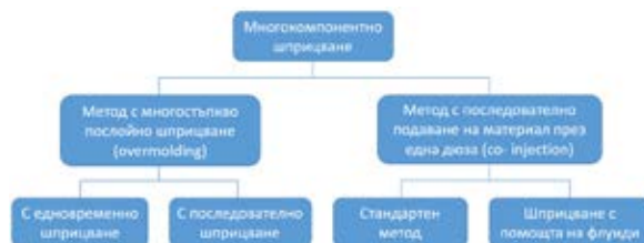
Фиг. 1 – Класификация на процесите за многокомпонентно шприцване
