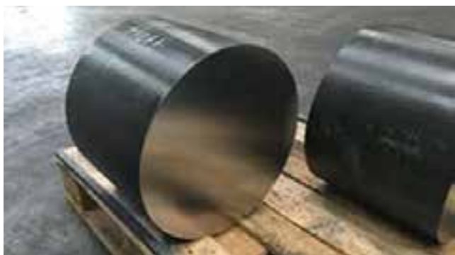
Фигура: Inconel 718 с диаметър 470 mm, обработен с високпроизводителен лентов трион FUTURA® 718
