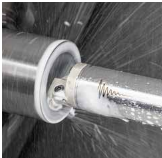
Фиг. 2 – В разстързването, антивибрационни щанги елиминират вибрациите и стабилизират процеса
