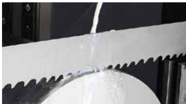
FUTURA® 718 Твърдосплавният лентов трион за рязане на пръти от легирани никелови стомани, от WIKUS.
