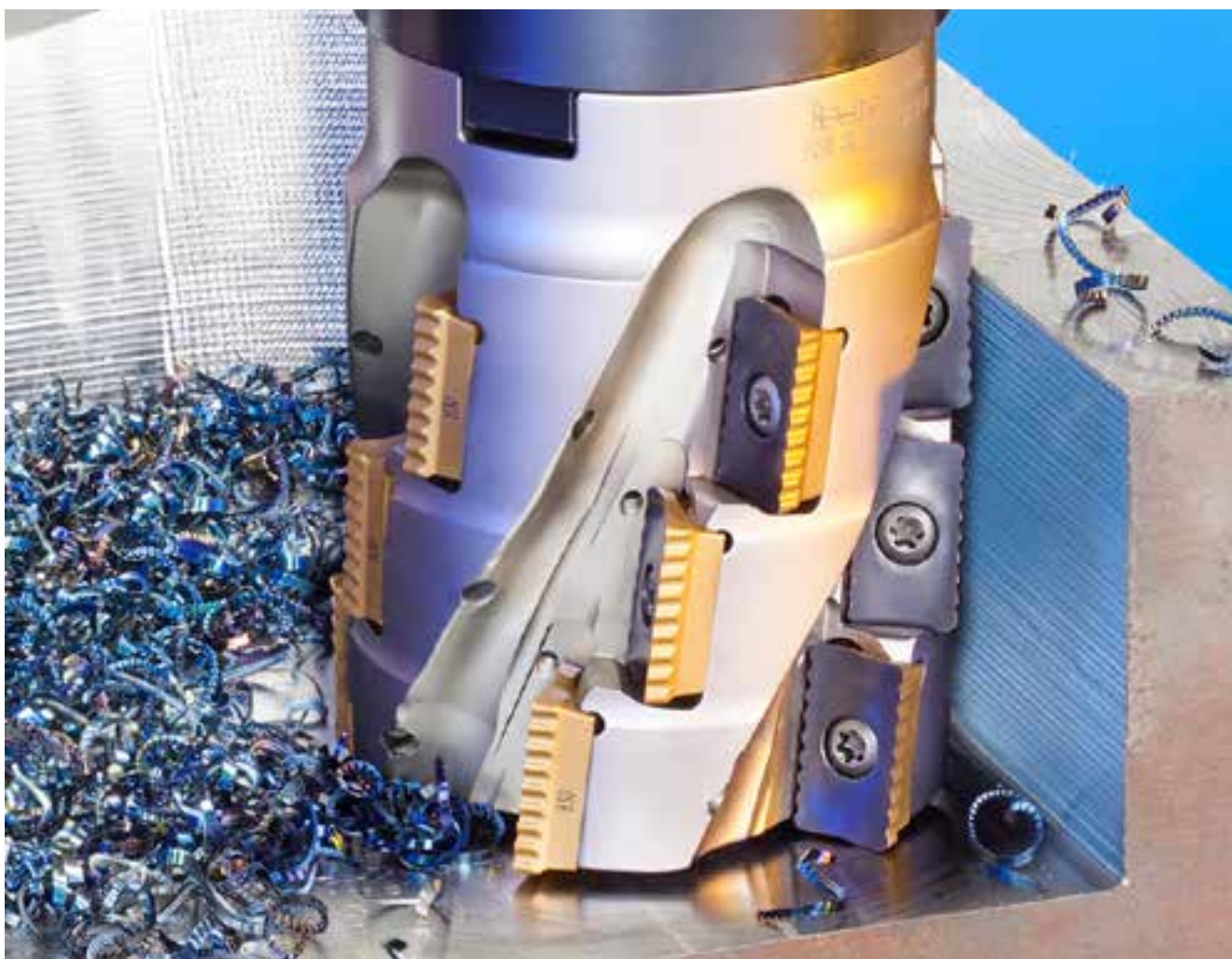
Fig. 3 – Стружкочупещата геометрия на MILLSHRED пластините стабилно фрезозване и контрол на стружките.
