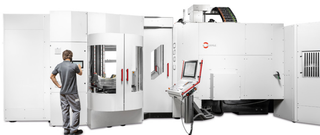
Манипулаторна система HS flex heavy с два модула за съхранение, адаптирана към 5-осен обработващ център C 650 – оптимален достъп също и за ръчни дейности
