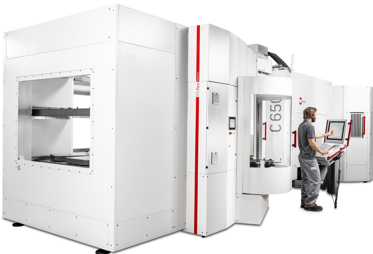
Манипулаторна система HS flex heavy с два модула за съхранение, адаптирана към 5-осен обработващ център C 650
