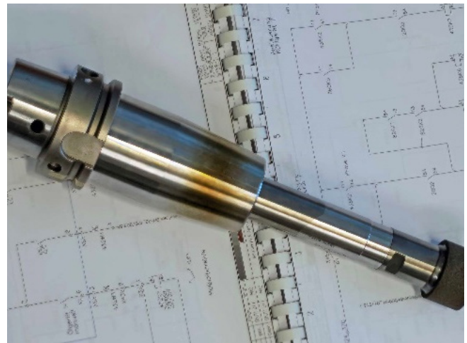
Двойна функция: В допълнение към фрезите и свредлата, в това приложение се използват и шлифовъчни дорници с абразивни инструменти от Krebs & Riedel (Снимка: Клаус Волрат)
