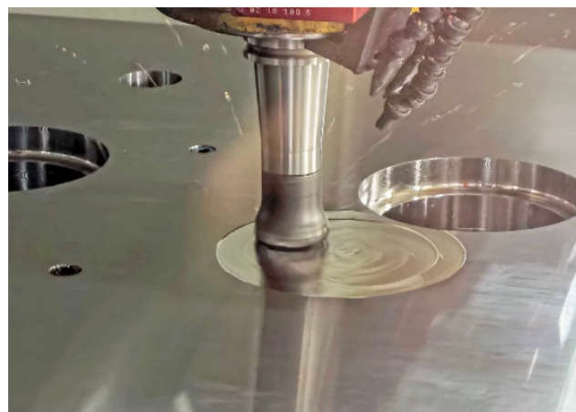
Стандартният шпиндел (101 Nm, 22 000 rpm) фрезова тестовия детайл с режеща глава с диаметър 52 mm (Снимка: Клаус Волпрат)
