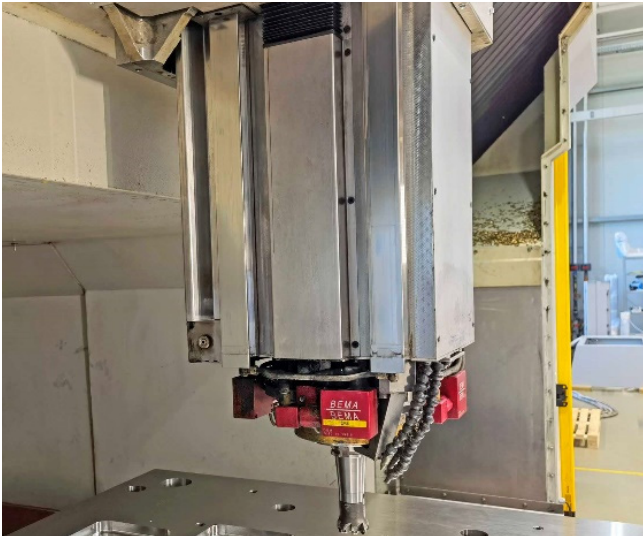
Принципът Quadroguide с четири направляващи в четирите ъгъла придава на Z-оста особено висока устойчивост (Снимка: Клаус Волрат)
