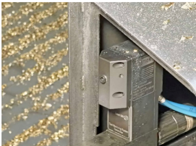
Лазерното устройство за измерване на инструменти е само едно от многото измервателни устройства, които системата използва, за да се самонаблюдава и да оптимизира процесите на обработка (Снимка: Клаус Волрат)
