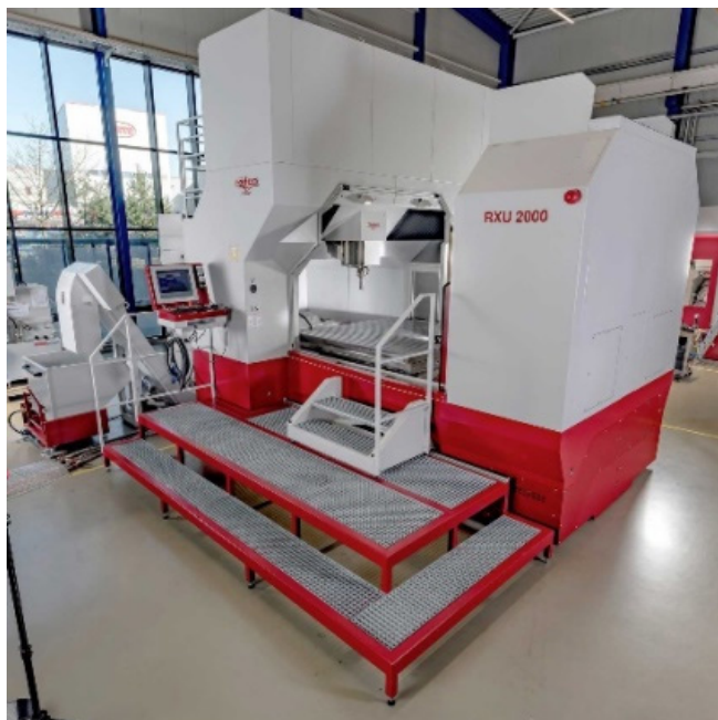
С работни размери от 2000 x 1800 x 800 mm, RXU 2000 е подходящ за бързо и високо прецизно фрезование и шлифование, дори на изключително твърди детайли (Снимка: Rödgers)
