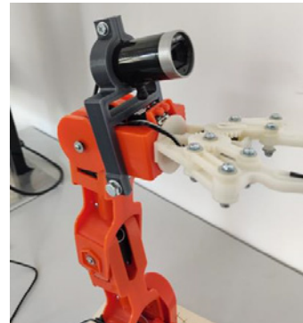
Фиг. 4 HD USB камера, закрепена над хващача
