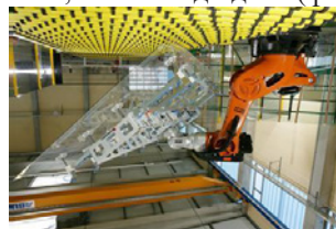
Фиг. 2 Робот KUKA в действие по преместване на стъкло
